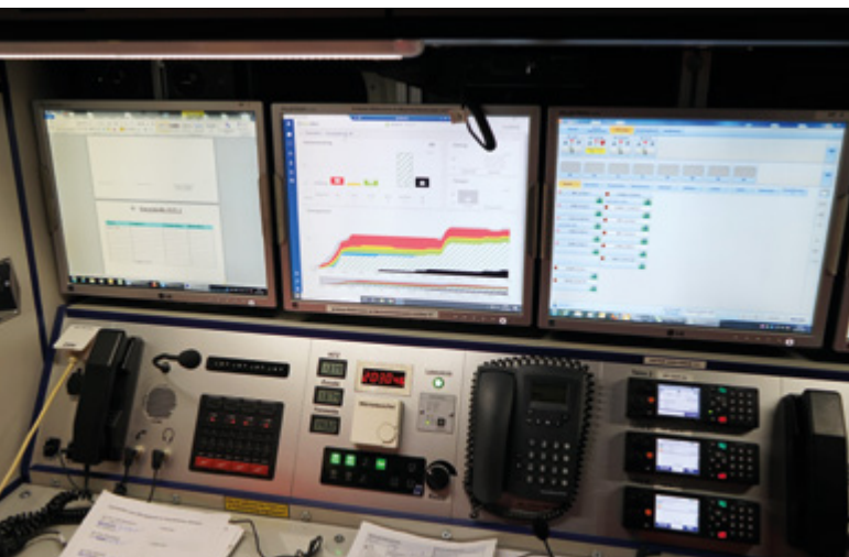
Abbildung 2: Ein ELW als Schnittstelle verschiedener IT-Systeme: Analog- und Digitalfunk, klassische Datenverarbeitungsprogramme und moderne Desktop-Apps. (Fotos: antwortING Beratende Ingenieure PartGmbH)
